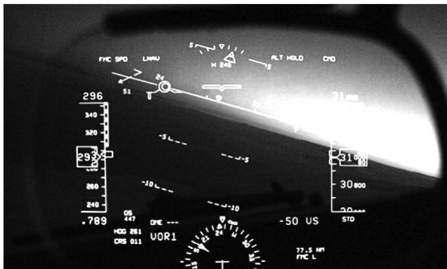
Abbildung 2.3.1.: Head-up-Display eines Kampffjetpiloten (vgl. [KR12], S.2)
