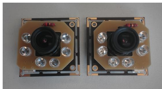
Abbildung 5.3.24.: Die geätzten Platinen des dritten Prototyps
