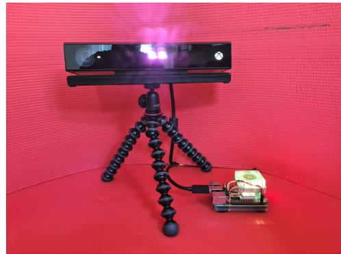
(b) Kinect v2 verbunden mit einem Einplatinencomputer (Raspberry Pi 4b + aktive Kühlung, 1.50 GHz, 8.0 GB RAM)
