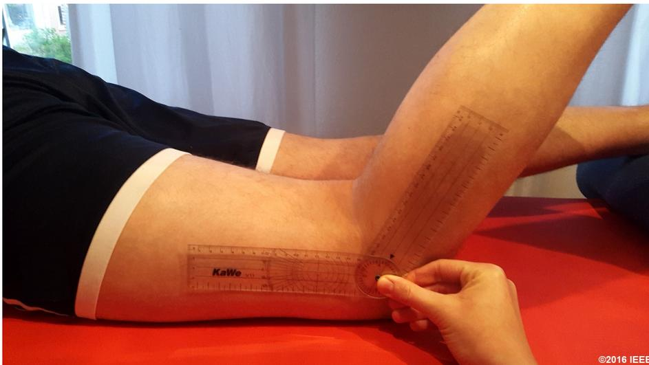
Abbildung 2.14.: Gelenkwinkelmessung der Flexion des linken Kniegelenks mit einem Standard-Goniometer [Vox and Wallhoff, 2016, Fig. 1]
