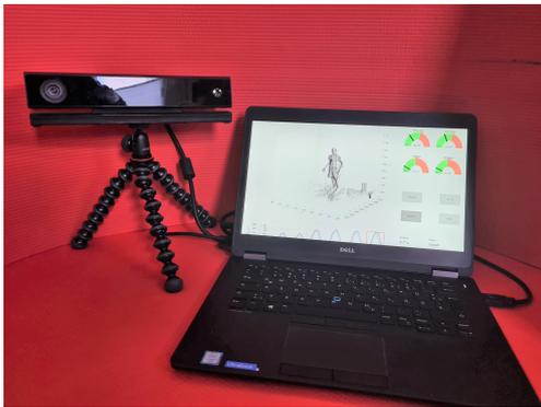
(a) Anwendung der automatischen Bewegungsbewertung auf einem Laptop (i7-6600U, 2.60 GHz, 16.0 GB RAM) mit der Kinect v2
