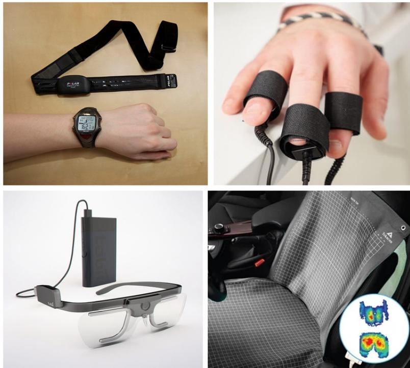
Abbildung 2.1: Links oben: Herzfrequenzmessgerät [Commons, 2009]. Rechts oben: Sensor zur Messung der elektrodermalen Aktivität [Zyto, 2022]. Links unten: Eye Tracker [Commons, 2014]. Rechts unten: Druckmatte für den Autositz [Sensors, 2022].
