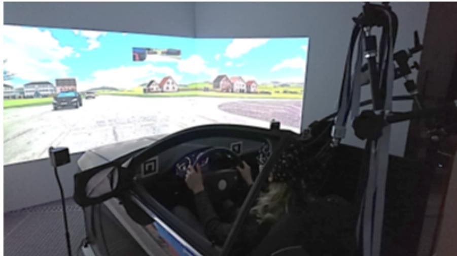
Abbildung 3.2: Der verwendete Fahrsimulator der Carl-von-Ossietszky Universität mit einer Probandin. Die Hirnaktivität während des Experimentes wird mithilfe eines fNIRS Systems gemessen.
