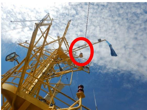
**Abbildung 62: Anemometer am Mast**
