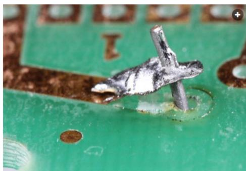
Wie kann man diese Lötstelle (das Lötpad hat sich von der Leiterplatte gelöst) am besten reparieren?
