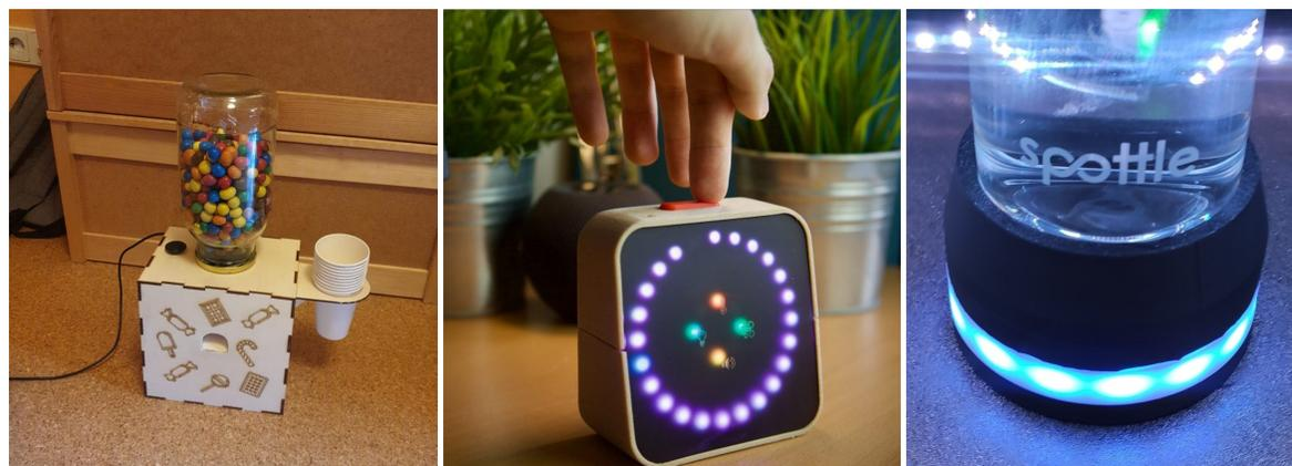
*Abbildung 3.35: Auswahl abgeschlossener Projekte. Ein smarter Süßigkeitenspender (links). Eine Lernuhr nach der Pomodoro-Technik (mitte). Miniaturwaage zur Erinnerung und Überwachung des Wasserkonsums (rechts)<sup>65</sup>*
