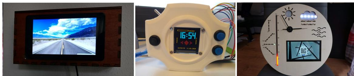
*Abbildung 3.16: Projekte aus der Veranstaltung von links nach rechts: Der smarte Bilderrahmen zeigt Bilder aus einer Cloudablage automatisch als Diashow an. DIY MP3-Player mit selbst entworfenem Gehäuse, Uhr, GUI, Energiesparmodi und Akkubetrieb. Die smarte Uhr zeigt das aktuelle Wetter, die Lufttemperatur, die Windrichtung und -stärke und Bilder im digitalen Bilderrahmen an <sup>46</sup>*
