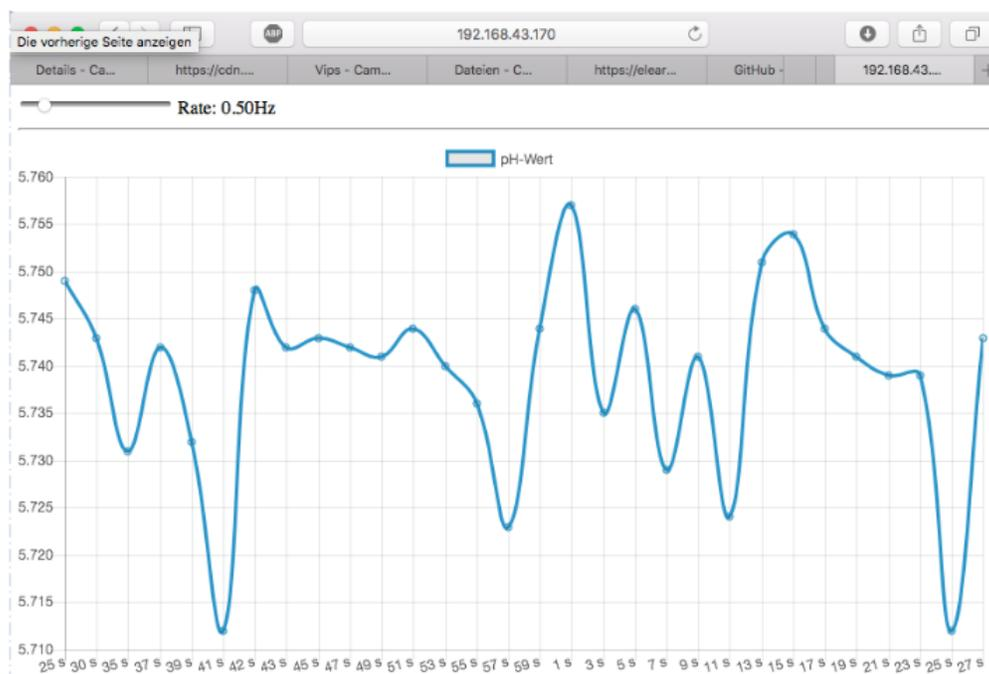
Abbildung 3.11: Screenshot von einem Webbrowser: das smarte pH-Meter sendet eine Titrationskurve in Echtzeit an das verbundene Endgerät
