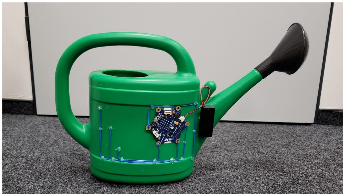
*Abbildung 3.8: Gießkanne mit Füllstandsüberwachung*
