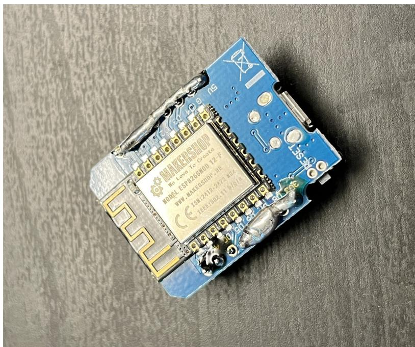
*Abbildung 3.23: Studentischer (defekter) Mikrocontroller: zu viel Lötzinn an den falschen Stellen*
