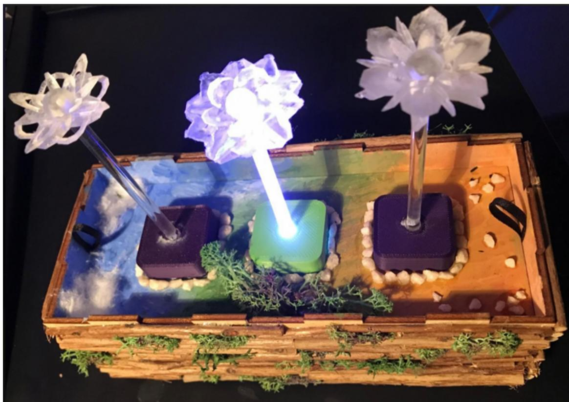
*Abbildung 3.22: Umfangreicheres Mini-Projekt einer Studentin: aufgrund der filigranen Modelle, wurden diese mit einem mSLA Drucker gefertigt. Zusätzlich wurde die Elektronik in einem Holzgehäuse aus dem Lasercutter versteckt<sup>54</sup>*
