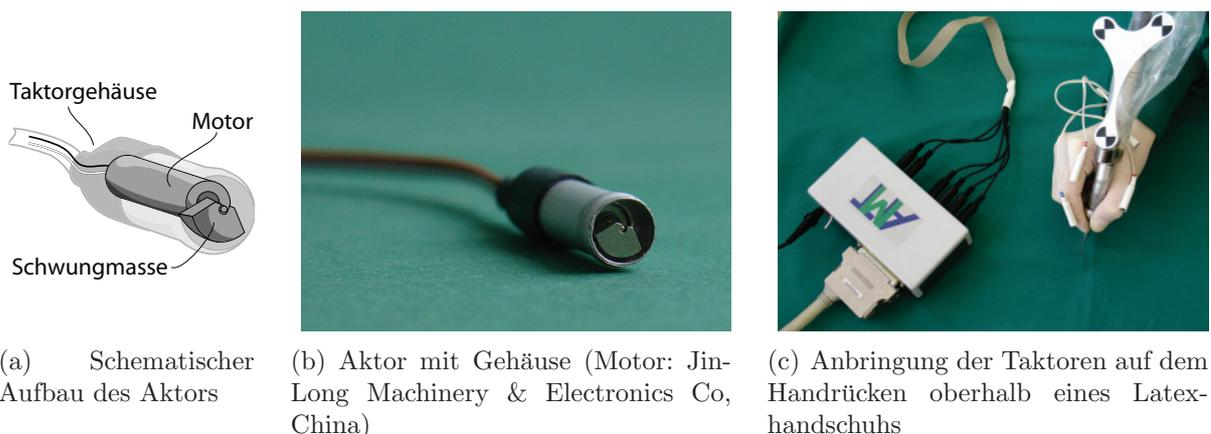
**Abbildung 5.3:** Vibrotaktiler Display bestehend aus bis zu 8 Gleichstrommotoren zur Erzeugung von Vibrationen auf dem Handrücken und den Fingeraußenseiten. Nicht sichtbare Aktoren sind auf der Handunterseite angebracht
