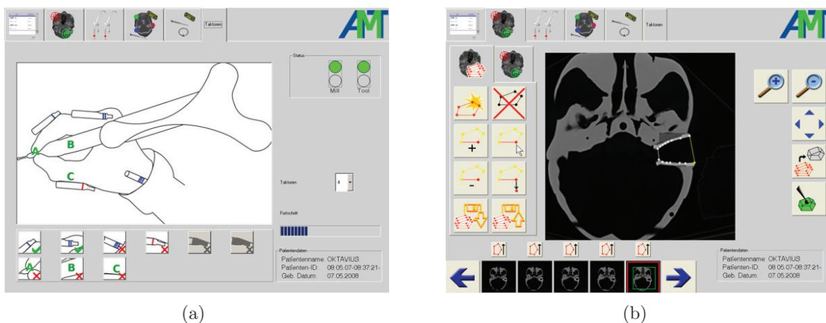
**Abbildung 5.38:** Oberfläche zur a) Kalibrierung des taktilen Displays zur Definition eines virtuellen Koordinatensystems für das Display, in dem die Positionen der Taktoren fest definiert sind, und b) Planung eines Eingriffs anhand von Polygonzügen.
