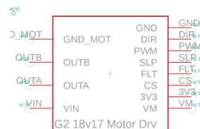
Abbildung 5.7: Schaltsymbol mit den verfügbaren Pins am Pololu G2 Motortreiber nach [29]
