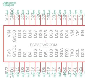
Abbildung 5.9: Schaltsymbol mit den verfügbaren Pins am ESP32-Controller nach [22]
