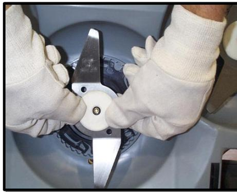
Abbildung 2.3.: Mähwerk eines Robomow [hanb]
