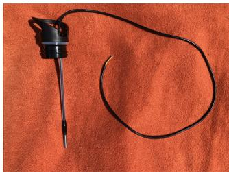
**Abbildung 2. Der verbaute Temperaturfühler**
